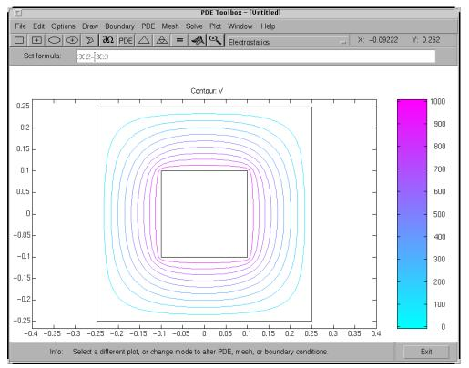
**Equipotential Lines in Air-Filled Frame**
